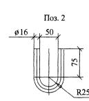
Сварку производить электродом Э42А ГОСТ 9467-75. Катеты швов  $k_{\rm f}=6$ мм. Приварку петли поз.2 производить после установки серьги поз.4 четырьмя швами длиной по 50 мм.
