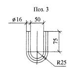
Сварку производить электродом Э42A ГОСТ 9467-75. Катеты швов  $\mathbf{k_f} = 6 \mathbf{mm}$ . Приварку петли поз.3 производить после установки серьги поз.5 четырьмя швами длиной по 50 мм.
