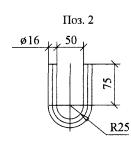
Сварку производить электродом Э42А ГОСТ 9467-75. Катеты швов  $\mathbf{k}_{\mathrm{f}}=6$ мм. Приварку петли поз.2 производить после установки серьги поз.4 четырьмя швами длиной по 50 мм.
