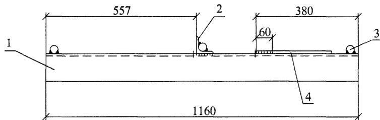
Сварку производить электродом Э42А ГОСТ 9467-75. Катеты швов  $k_f = 6$ мм.
