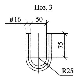
Сварку производить электродом Э42А ГОСТ 9467-75. Катеты швов  $k_f = 6\text{мм}$ .
