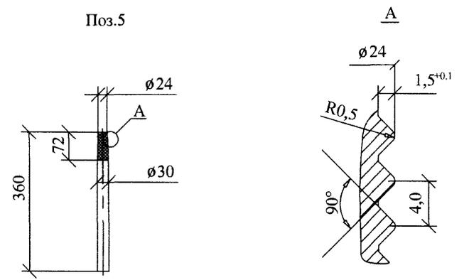
Сварку производить электродом Э42А ГОСТ 9467-75. Катеты швов  $k_f = 6\text{мм}$ .
